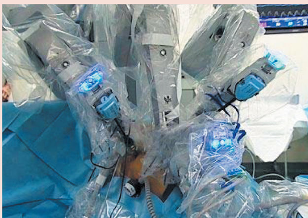
Манипуляторы робота Da Vinci
